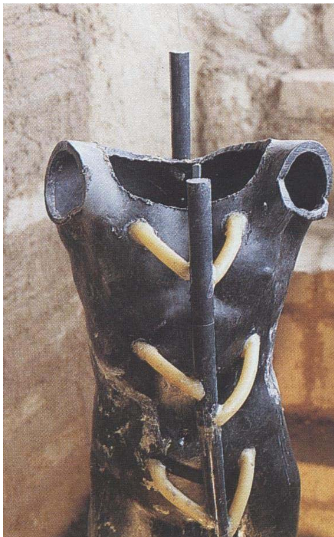
Applicazione dei canali di sfiato alla forma di cera.
