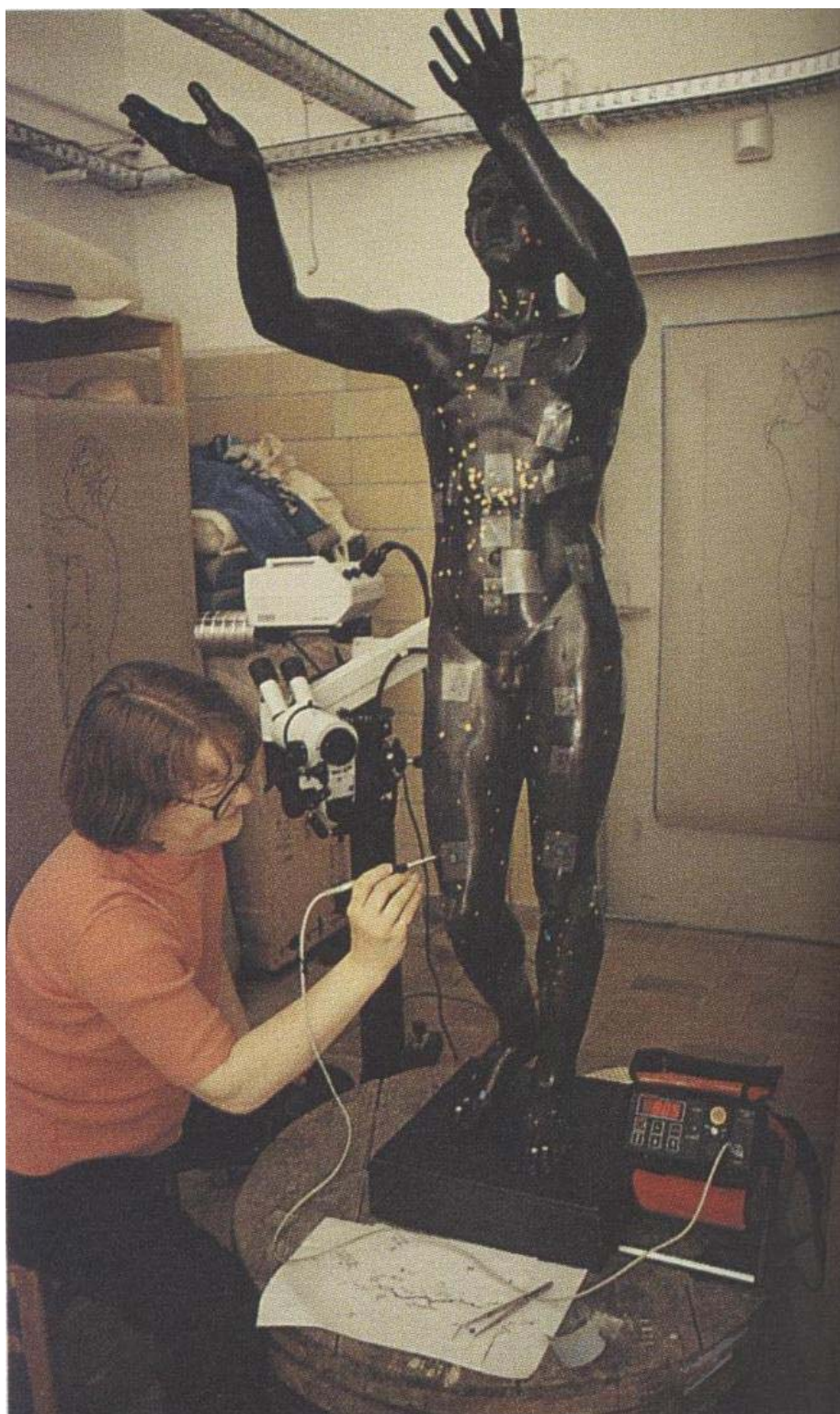
Indagini archeometriche sul bronzo originale ellenico prima di approntare la forma in cera e riprodurre la statua nella fossa di fusione di Murlo.
