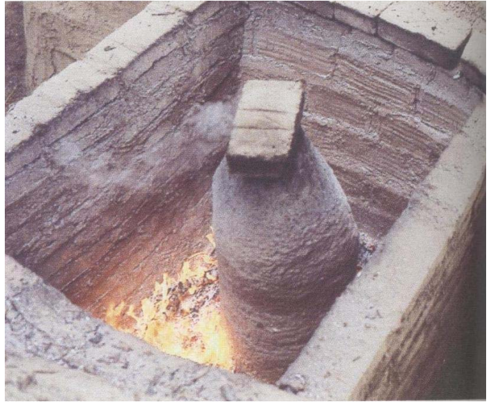
Cottura della forma nella fossa di fusione per la fuoriuscita della cera della forma.
