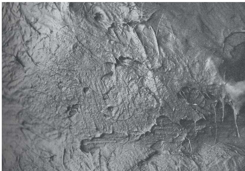
Impasto di terra refrattaria e peli utilizzata per il mantello esterno della forma.
