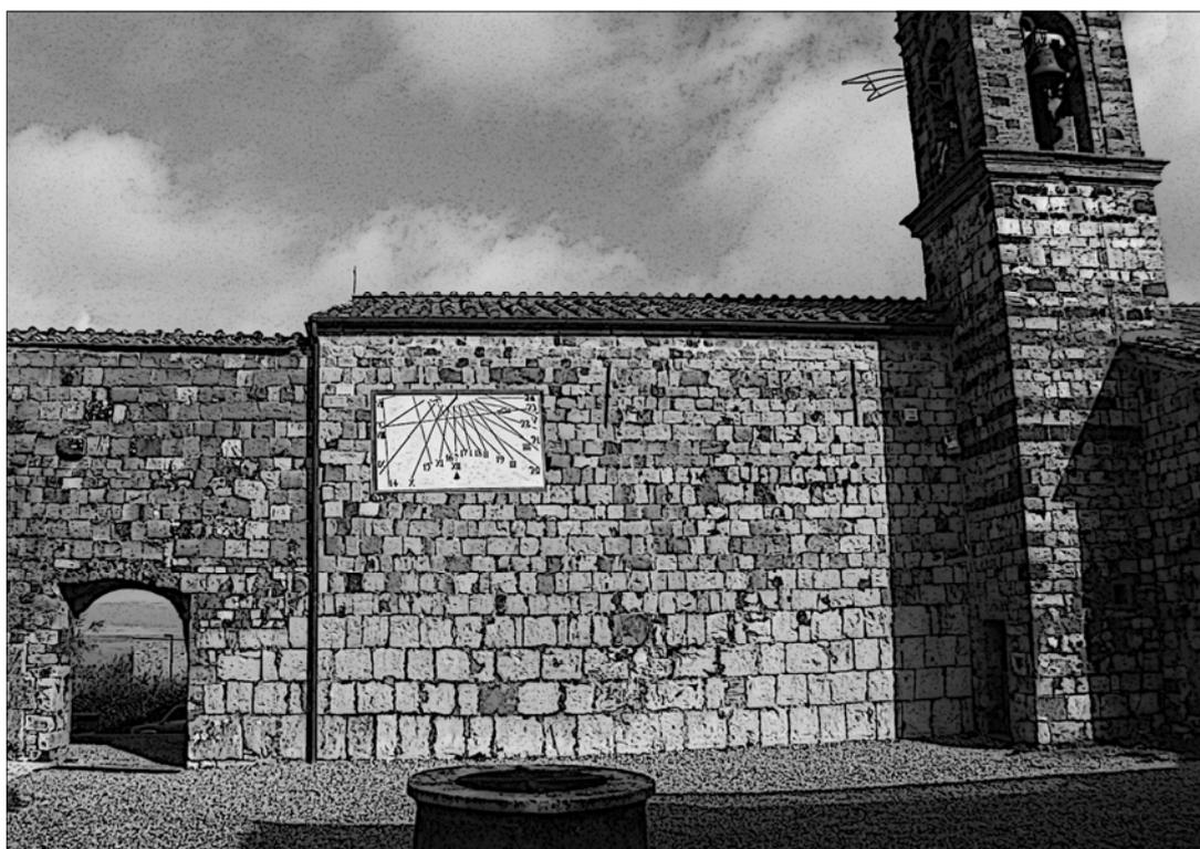
Fig. 2. Una possibile ricostruzione della meridiana di Casciano, con linea equinoziale, linee delle ore vere e italiane (ore al tramonto) con uno stile tipico dell'epoca. L'immagine della meridiana è ripresa da un restauro di Mario Arnaldi alla fattoria Felsina (Castelnuovo Berardenga).
